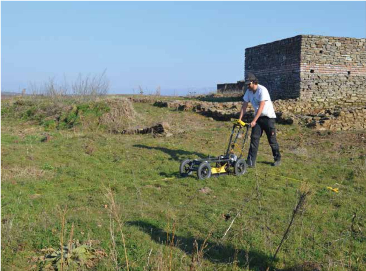
Георадарска снимања Горњег града, 2015. (снимио Вујадин Иванишевић) GPR recordings of Upper Town, 2015 (photo by Vujadin Ivanišević)
